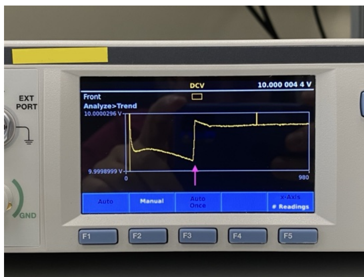
Obr. 61: Skok výstupného napätia referencie po dosiahnutí nominálnej teploty termostatu.
