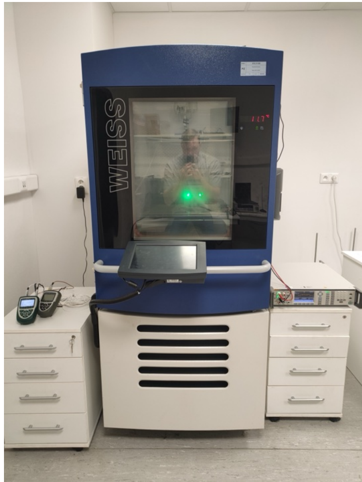
Obr. 86: Meranie teplotnej stability etalónu v laboratóriu SLM. Vľavo referenčné teploměry, v pravo referenčný mnohomer.
