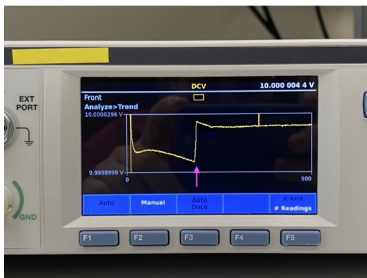
Obr. 61: Skok výstupného napätia referencie po dosiahnutí nominálnej teploty termostatu.
