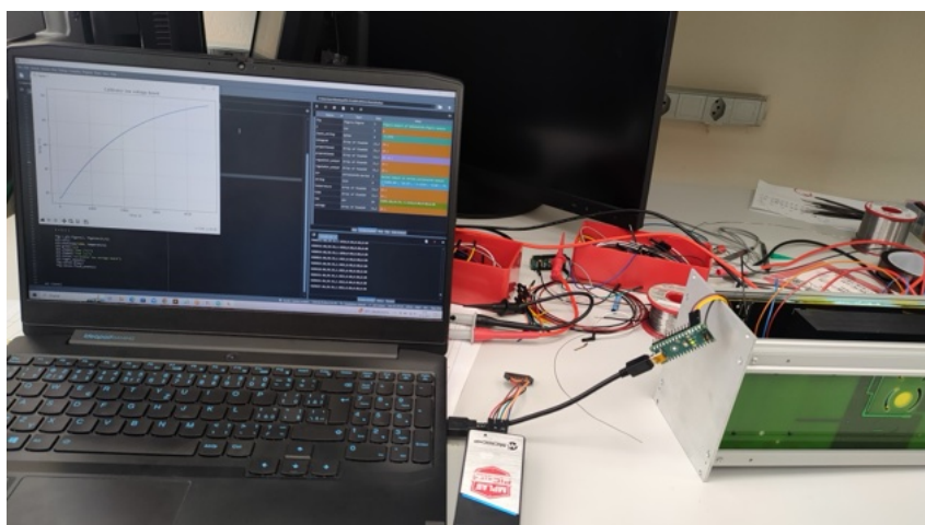
Obr. 39: Meranie skokovej odozvy regulátora teploty.
