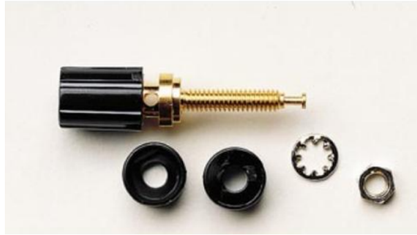
Obr. 55: Výstupný konektor etalónu, Pomona electronics typ 3770.
