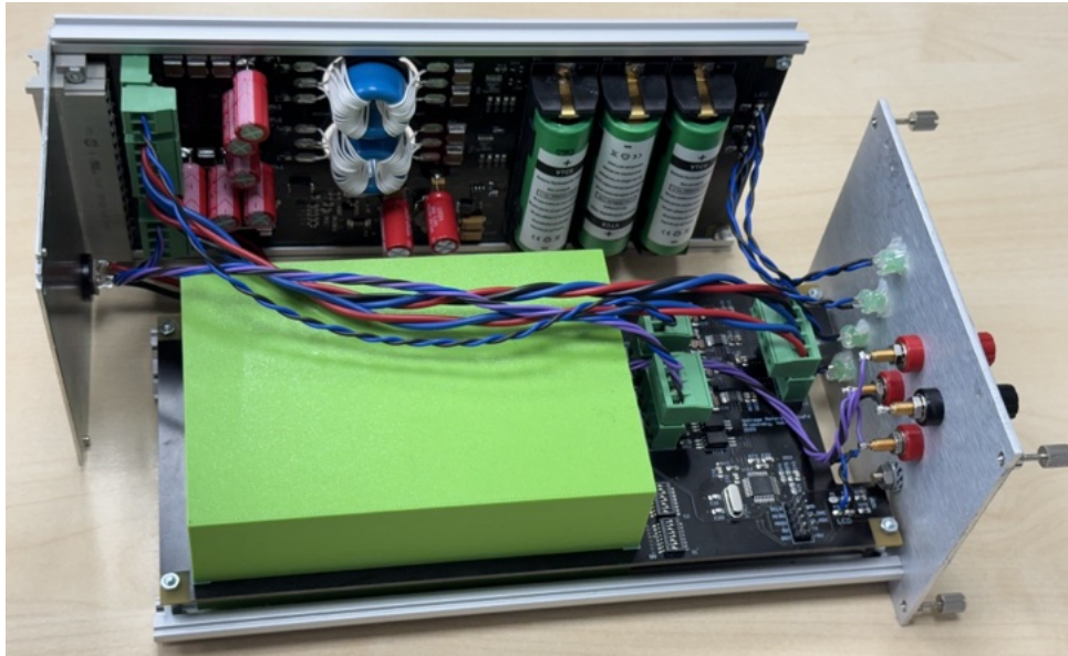
Obr. 59: Integrácia elektroniky referencie do zásuvného modulu. Zelená krabička je 3D vytlačená tepelná izolácia.
