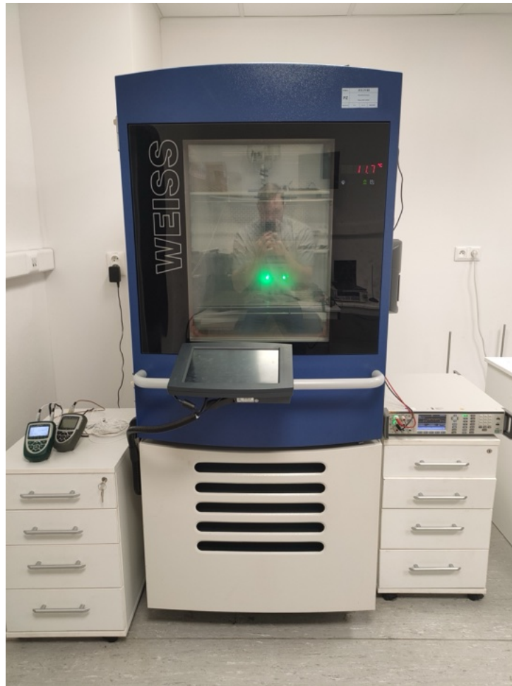
Obr. 86: Meranie teplotnej stability etalónu v laboratóriu SLM. Vľavo referenčné termometry, v pravo referenčný mnohomer.
